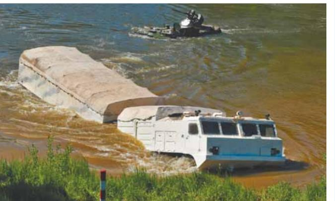
четырьмя ведущими колесами. Уникальная машина отвечает самым жестким требованиям Минобороны и получила очень высокую оценку при опытной войсковой эксплуатации. Машина гарантированно обеспечивает защиту экипажа и десанта, защищает людей от бронированной пули снайперской винтовки, подрыва мины или спрятанного на обочине самодельного взрывного устройства эквивалентом до шести килограммов взрывчатки.
