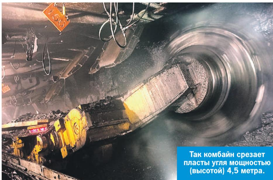
Так комбайн срезает пласты угля мощностью (высотой) 4,5 метра.
