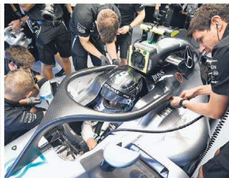
Некоторые пилоты «Формулы-1» жалуются на то, что новая система защиты головы гонщиков Halo ухудшает обзор и усложняет процесс покидания машины в экстренных ситуациях. ФОТО HOCH ZWEI VIA ZUMA WIRE/TACC
