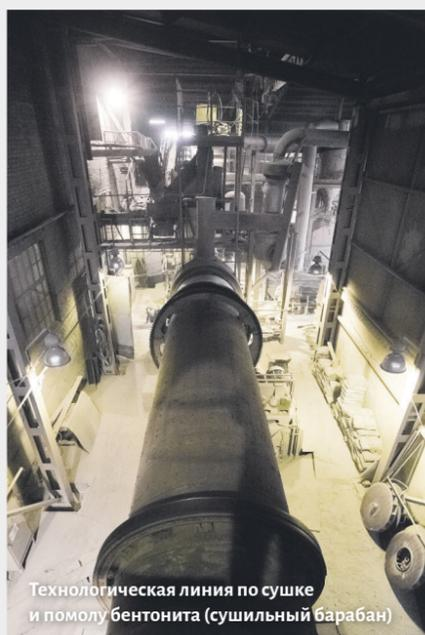
Технологическая линия по сушке и помолу бентонита (сушильный барабан)
